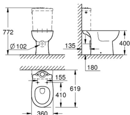
39 428 000 **BAU CERAMIC VASO A PAVIMENTO PER CASSETTA DI SCIACQUO ESTERNA**
